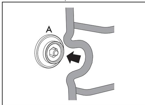
3. Apertar o perno de fixação dianteiro (é possível ajudar-se com um utensílio, por exemplo uma moeda).
